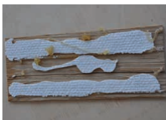
Essai d'adhérence sur un échantillon Wall
